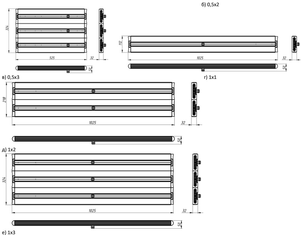
Рисунок 1 – Варианты светильников Element (см. таблицу 1) без системы крепления.
