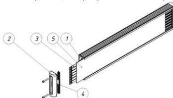
Рисунок 2 – Конструкция светильника Geniled Element 36В.
